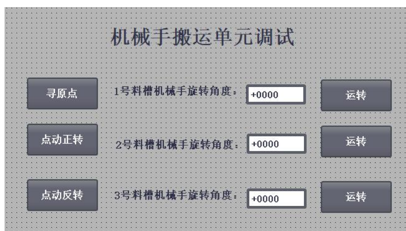
图 3 机械手搬运单元触摸屏参考界面
