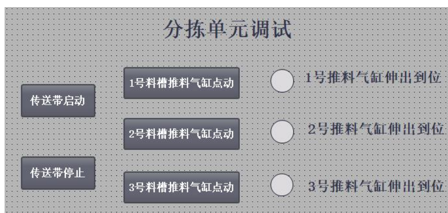
图 4 分拣单元触摸屏参考界面
